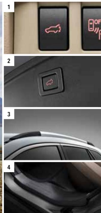
1. Commutateur de hayon à commande électrique sur la planche de bord
