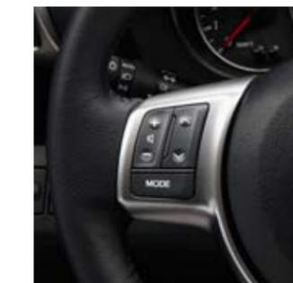
**COMMANDES AUDIO AU VOLANT (modèles S et L)**
