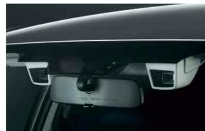
L'EyeSight, ce dispositif qui met en œuvre deux caméras fonctionnant en stéréo, surveille la route et prévient le conducteur en cas de collision imminente.
