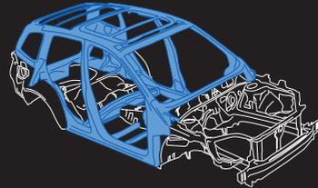
Les structures de renfort annulaires renforcent l'habitacle, du toit jusqu'aux portes, des montants jusqu'au plancher. En cas de collision, elles contribuent à dissiper l'énergie du choc en l'éloignant des occupants, via des matériaux ultra-résistants placés en des endroits stratégiques. Si la structure gagne en robustesse par une meilleure rigidité en torsion, elle reste légère.
