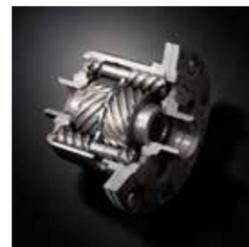
Différentiel à glissement limité Torsen équipant la WRX STI.
