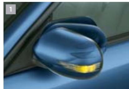
Rétroviseurs électriques rabattables avec clignotants à LED intégrés
