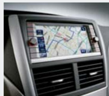
Système de navigation à DVD avec écran VGA haute résolution / système audio haute qualité avec Audyssey MultEQ\*1 \*2
