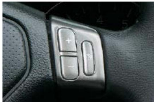
Commande radio au volant (avec système audio haute qualité)
